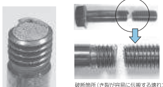
図1（b） 従来法（焼入れおよび焼戻し処理）で作製した六角ボルト（M12） ボルト製品の引張強度＝1833MPa
