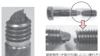
図1（a） 開発した六角ボルト（M12） ボルト製品の引張強度＝1848MPa
